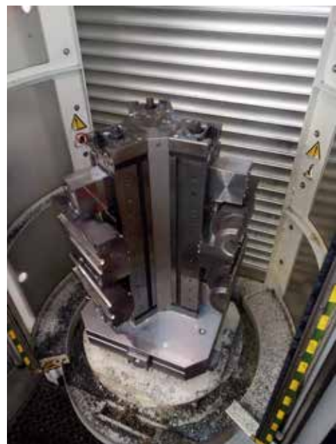
Cubomorsa FMS con ganasce speciali per presa stampi di bottiglia FMS vise tower with special jaws to clamp bottle moulds
