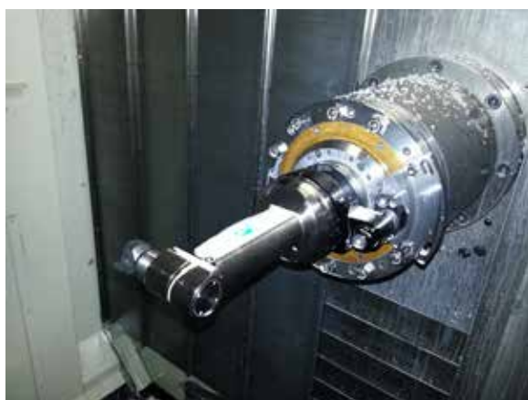
F90-10L uscita Weldon 10 su centro di lav. OKK F90-10L Weldon 10 exit on a OKK machine tool
