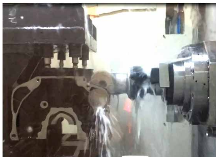
Lavorazione con testa F90 S40 con porta fresa a disco su corpo motore.
