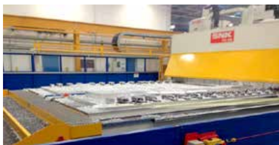
Morse standard automatizzate su una macchina con tavola lunga 30 metri Automated standard Visers on a 30 meter long machine tool
