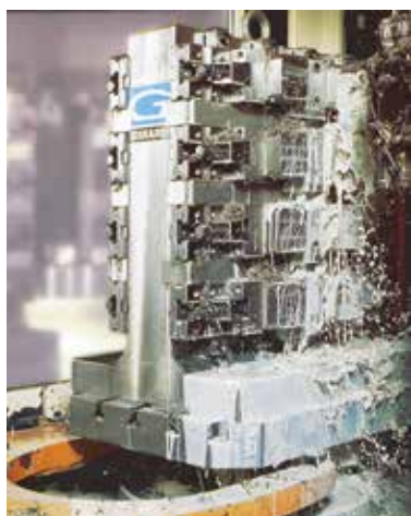
Morse XL doppie montate su spalla in orizzontale XL double vises horizontally assembled on a 2 sides tombstone
