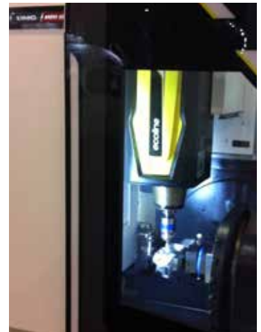
Applicazione per aeronautica Morsa Multitasking e Zero point montati su macchina DMG modello DMU 50 Ecoline Aerospace application for Multitasking Vise and Zero Point on DMG machine DMU 50 Ecoline Model
