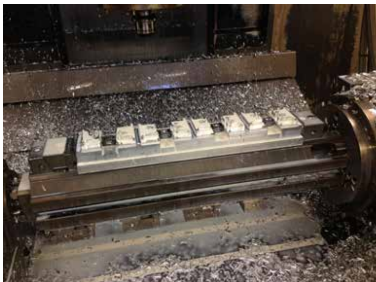
Cubomorsa Multiflex con relativa piastra di interfaccia montato su tavola girevole Multiflex vise tower with interface plate assembled on rotary table
