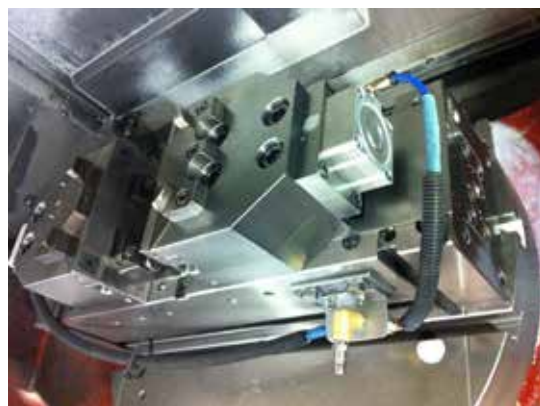
Morsa FMS (con ganasce oscillanti e puntalini meccanici) per serraggio pezzi irregolari FMS vise (with floating jaws and mechanical grip points) for irregular workpieces clamping
