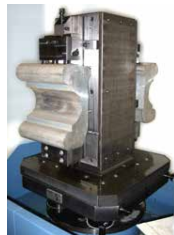
Cubo per piastre riportate con montate piastre ed elementi modulari con sovraganasce Tombstone with modular plates, fixed and movable vise sections and stack type jaws assembled
