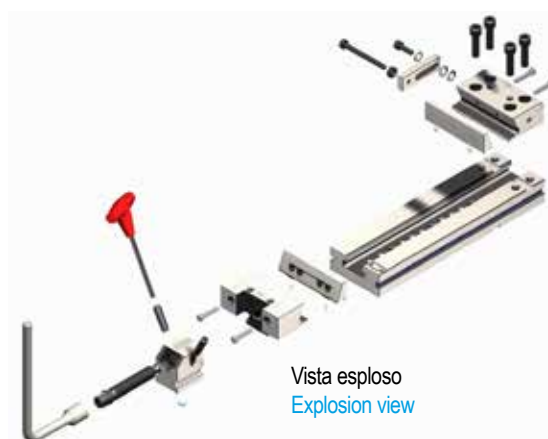
Alternative di posizionamento: 2 chiavi trasversali - 2 chiavi longitudinali - 2 spine cilindriche rettificate di posizionamento
