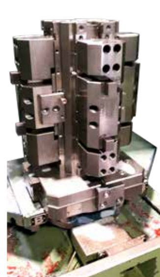
Cubomorse FMS progettato con principio di spinta a 45 gradi per serrare 2 sbocchi di turbina su ogni faccia per la loro prima operazione.
