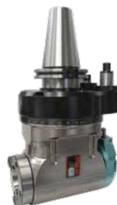
Testa Angolare F90-S40 70-bar con gruppo antirotante speciale per OKUMA 800VH Angle Head F90-S40 70-bar with special anti rotation group for OKUMA 800VH
