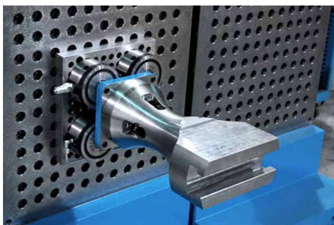
Special aluminum zero point fixture on Haas machine and rotary table Attrezzatura speciale con zero point applicata su tavola girevole e macchina Haas
