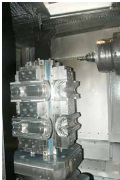
Cubomorsa FMS con ganasce speciali per presa stampi di bottiglia FMS vise tower with special jaws to clamp bottle moulds
