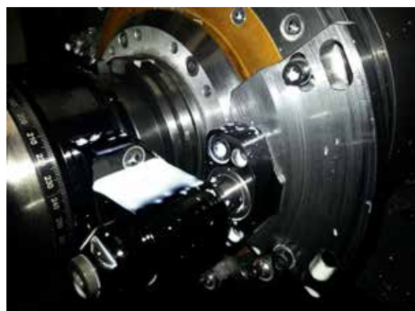
Stop block fissato sul mandrino grazie ad uno SPECIALE Distanziale tra mandrino macchina e stop block Stop block fixed on the machine spindle thank to a SPECIAL Spacer between the machine spindle and the stop block
