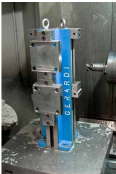
Particolari fuori dimensione ma lavorati su cubo Multiflex Art.607 tipo 2 - Rather big work-pieces machined on a Multiflex vise tower Art.607 Type 2_pic2
