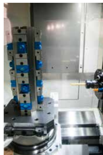
Cubo morsa MULTIFLEX montato su divisore in orizzontale per applicazione su centri di lavoro verticali MULTIFLEX vise tower assembled on a horizontal dividing head for application on vertical machining centre
