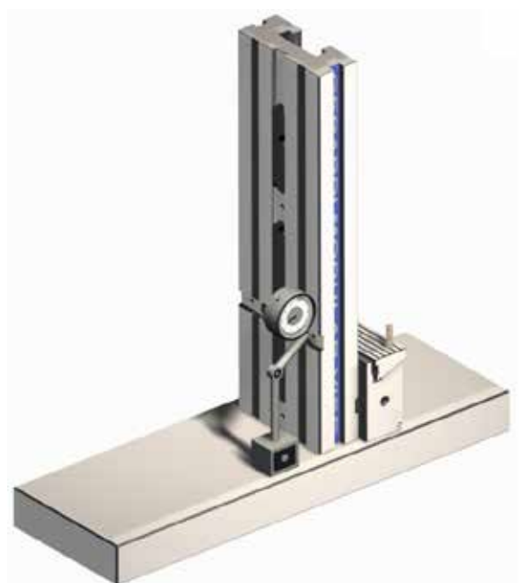
Miglior controllo per verifica allineamento morsa (ganasca fissa - chiave trasversale)
