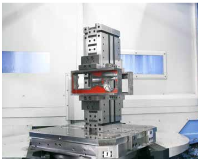
Cubo di morse autocentranti FMS montate in verticale con ganasce lisce a gradino per pezzi quadrati
