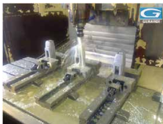
Morse modulari montate verticalmente su cubo portapezzi per lavorazioni su centro orizzontale Modular Visers vertically assembled on a tombstone for horizontal machining centre.
