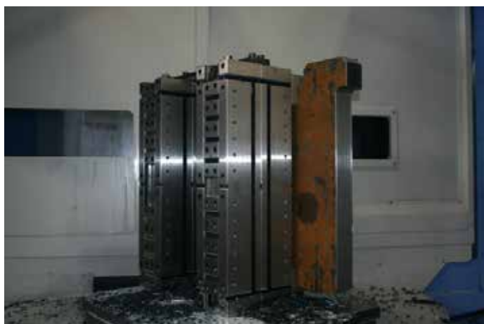
Esempio di massima capacità di presa pezzo delle morse FMS per un miglior utilizzo delle corse del centro di lavoro orizzontale
