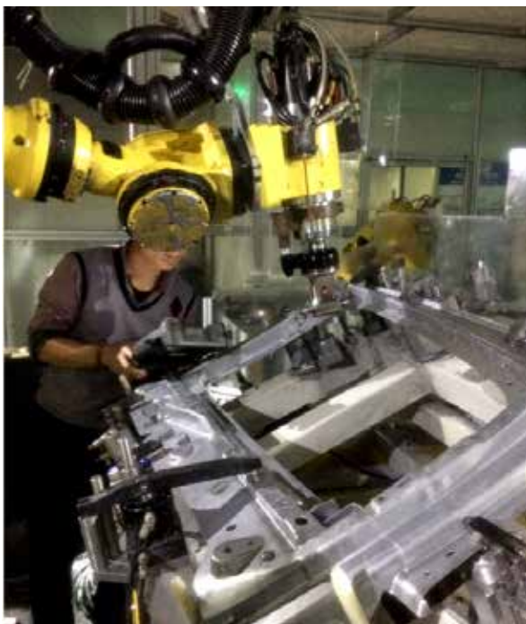
Applicazione speciale su robot FANUC testa doppia uscita Special application angle head double output on FANUC robot
