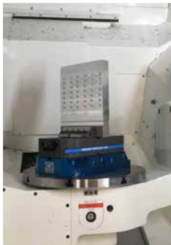
Morsa Compact Grip montata su Kitamura Mytrynnion 4G per la lavorazione di uno stampo nel settore plastica.
