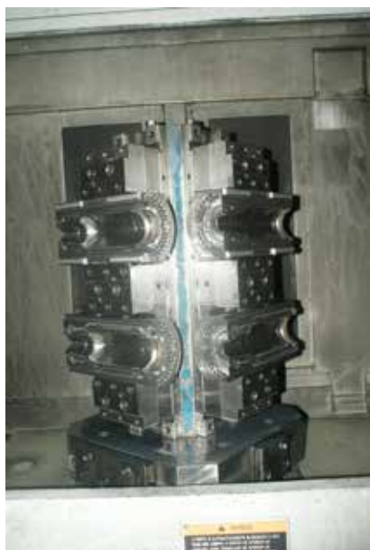
Cubomorsa FMS con ganasce speciali per presa stampi di bottiglia FMS vise tower with special jaws to clamp bottle moulds
