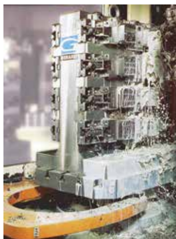
Morse XL doppie montate su spalla in orizzontale XL double vises horizontally assembled on a 2 sides tombstone
