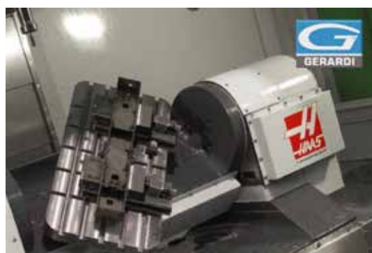
Morse Art.1 montate su tavola basculante per macchina a 5 assi Art.1 visers assembled on a dividing head for a 5 axis machine
