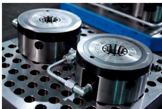
Special aluminum zero point fixture on Haas machine and rotary table Attrezzatura speciale con zero point applicata su tavola girevole e macchina Haas
